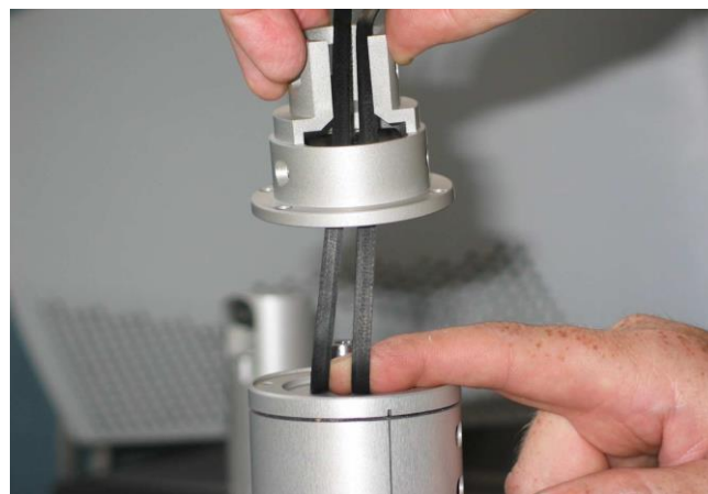
Imagen 8. Courroie entre rouleaux et mur tendeur
