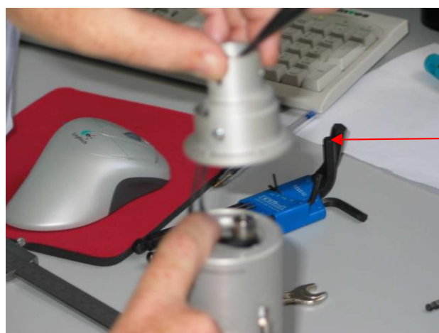
Imagen 5. Démontage du DRT
